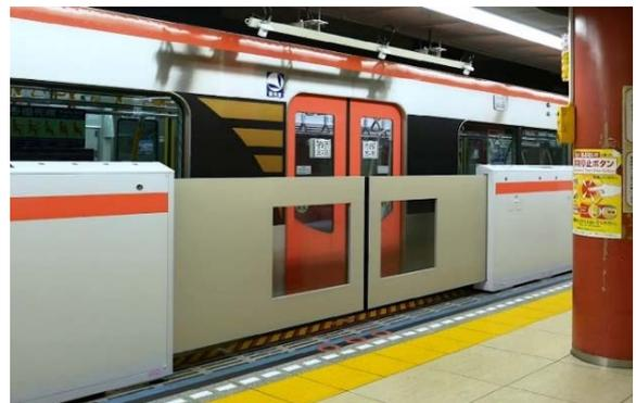
QR コードを車両ドアに貼り、ホーム上のカメラ（読み取り装置）で車両ドア数、編成車両数などの情報や QR コードの動きを検知します。そうすることで、車両ドアの開閉に合わせてホームドアを開閉します。
